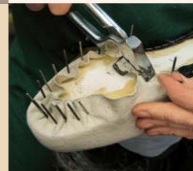
Fixieren des Innenfutters an der Innensohle
