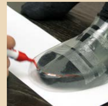
Der Kunststoffabguss des Leistsens wird anprobiert und korrigiert
