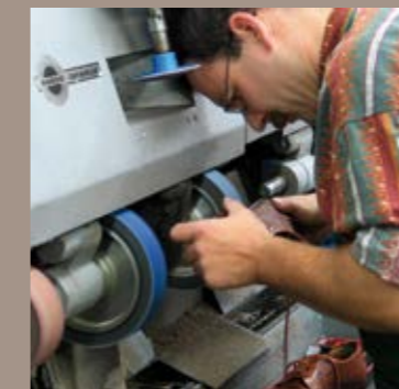
Schleifarbeiten beim Bodenbau des Schuhs
