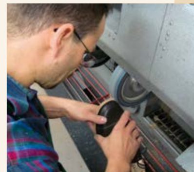
Schleifen der Sohle
